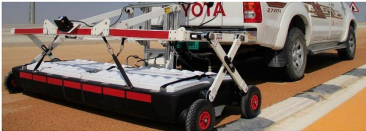
**Esempio 3D: MALA MiniMIRA array da 9 antenne da 400MHz**
